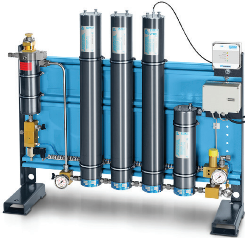
Filtersystem P 100 mit SECURUS, Kondensatablassautomatik und CO-Umwandlung
